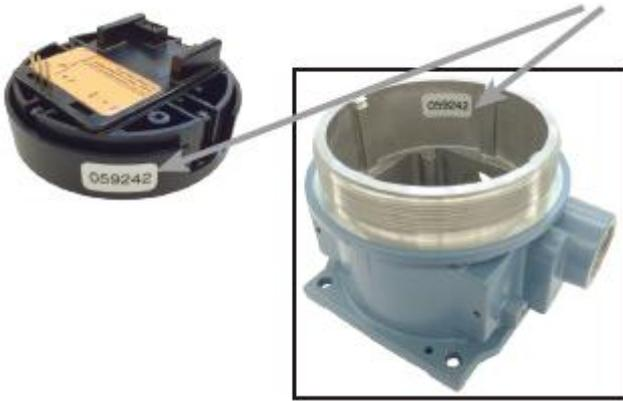
**注意：**不要更换单系列显示模块或压力传感器。在设备之间交换这些数据将导致存储的传感器校准数据和压力传感器之间不匹配。为了正确操作，显示模块序列号必须始终与机柜内的序列号匹配（参见图 12）。
